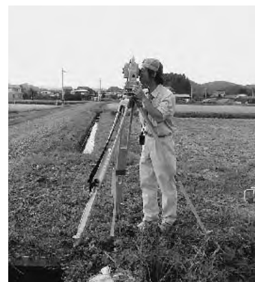
トータルステーション測量風景
