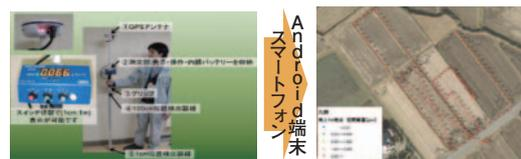
測定器を持ち歩くだけで測定位置と放射線量の値が画面に表示されます。
