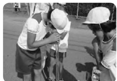
透視度計を用いて水の透明度を測定している様子
