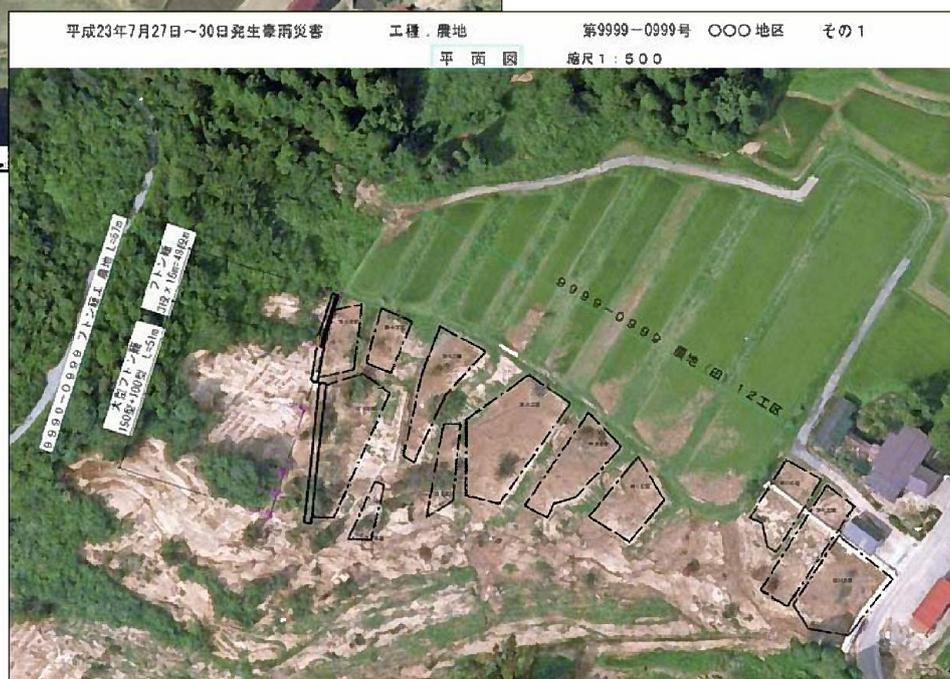
②被災後の航空写真から、法面崩壊範囲や崩壊土砂堆積範囲等が明らかになる。
