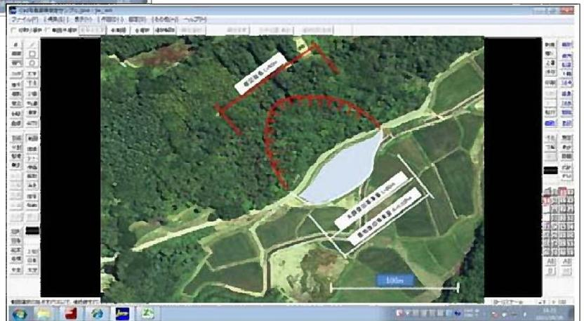
被災前の航空写真(デジタルオルソ画像)に復旧事業量を重ね合わせ、平面図として活用
