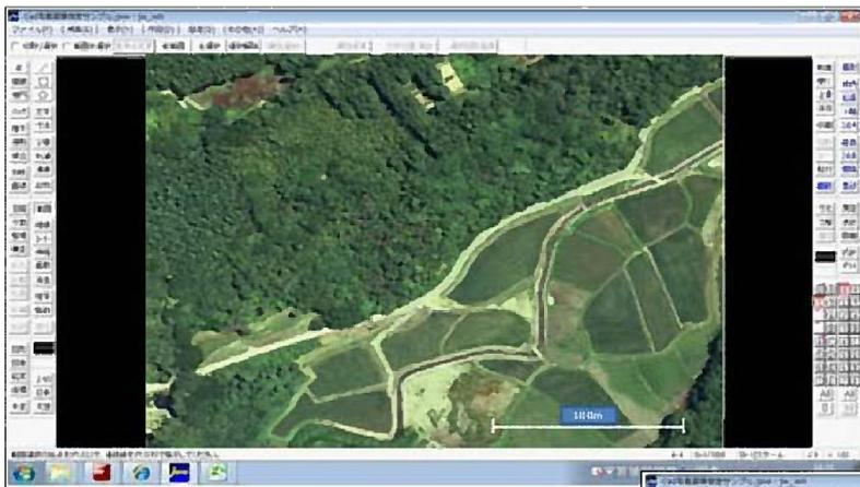
①被災前の航空写真をCADに取り込み、必要な縮尺に調整
